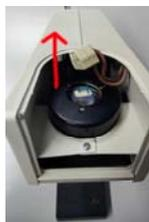
4) Ruotare in senso antiorario facendo una leggera pressione e sbloccare la ghiera nera posta sopra alla lampadina
